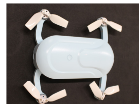
手のひらサイズの小型ドローン。山奥、崖の下、河原、茂みなど人が入れない危険な場所も迅速に調査
